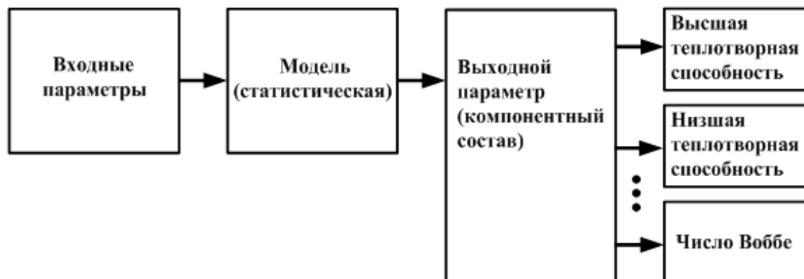
Рисунок 2.5.1.2 — Схема аналитического метода определения энергетических характеристик по компонентному составу
