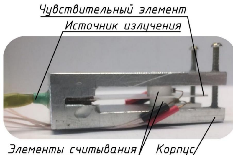
Рисунок 66 – Макет преобразователя линейного ускорения с оптическим считыванием
