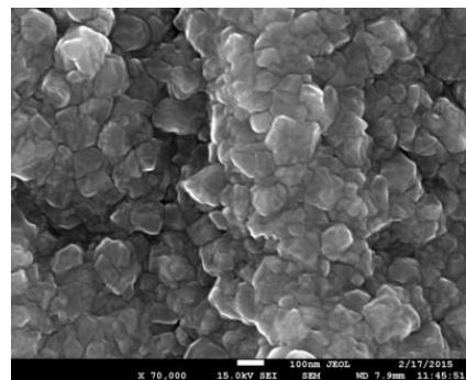
Рис. 2 - Изображение СЭМ покрытия из BN.
