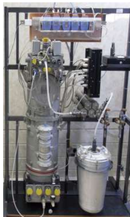
Система «Электрон — ВМ» (источник кислорода на борту КА)
